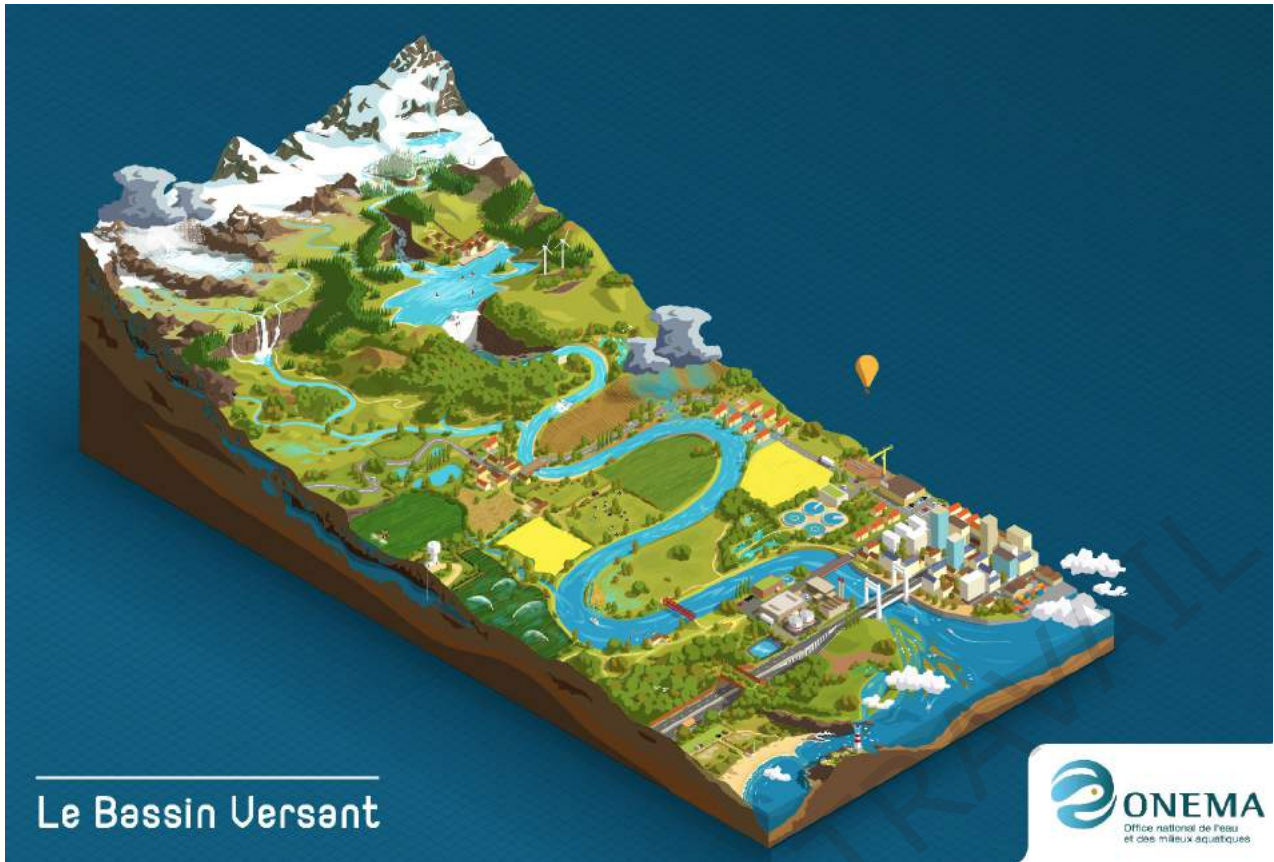
Figure 1 : Un bassin versant est une portion de paysage où le relief permet à l'eau de pluie de ruisseler sur une pente pour aller alimenter un cours d'eau. Ce point de convergence de l'écoulement de l'eau (exutoire) peut également se traduire par un lac ou la mer. (Source image: Matthieu Nivesse, ONEMA).
